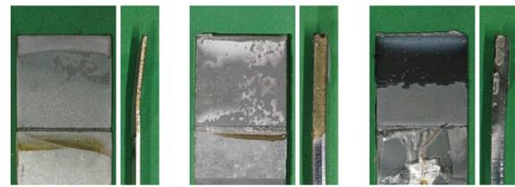
図 6 接着領域の破壊状態 ( $A_a = 10$  cm<sup>2</sup>,  $l_a/b_a = 1:1$ )
